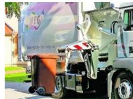
im Altkreis Niesky der Biomüll mit einem Seitenlader (siehe Foto) entsorgt werden, bei dem durch eine moderne Schüttvorrichtung die Abfallbehälter seitlich gekippt und durch den Fahrer bedient werden.
